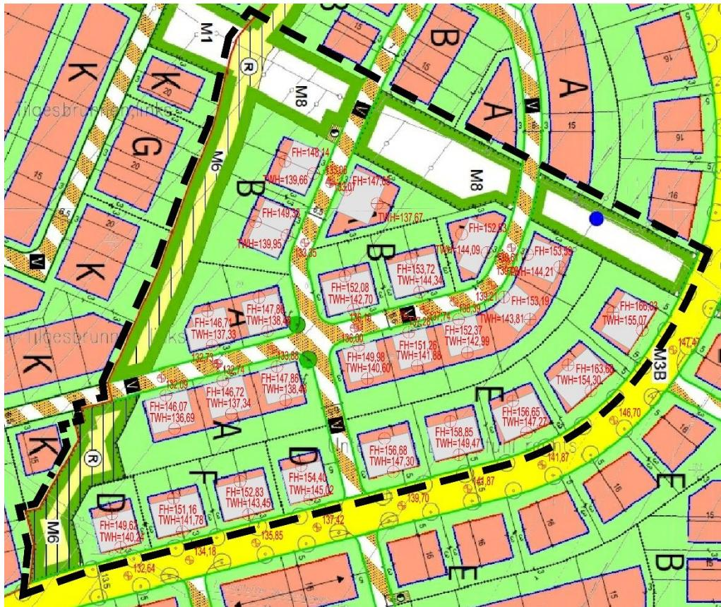
Abbildung 1: Mögliche Bebauungsvariante nach bisher gültigem Bebauungsplan; blaue Linien: Baugrenzen; hellgraue Flächen: beispielhaftes Bebauungskonzept; rote Beschriftung: FH für Firsthöhe, TWH für Traufwandhöhe, Höhenangaben ü. NN
