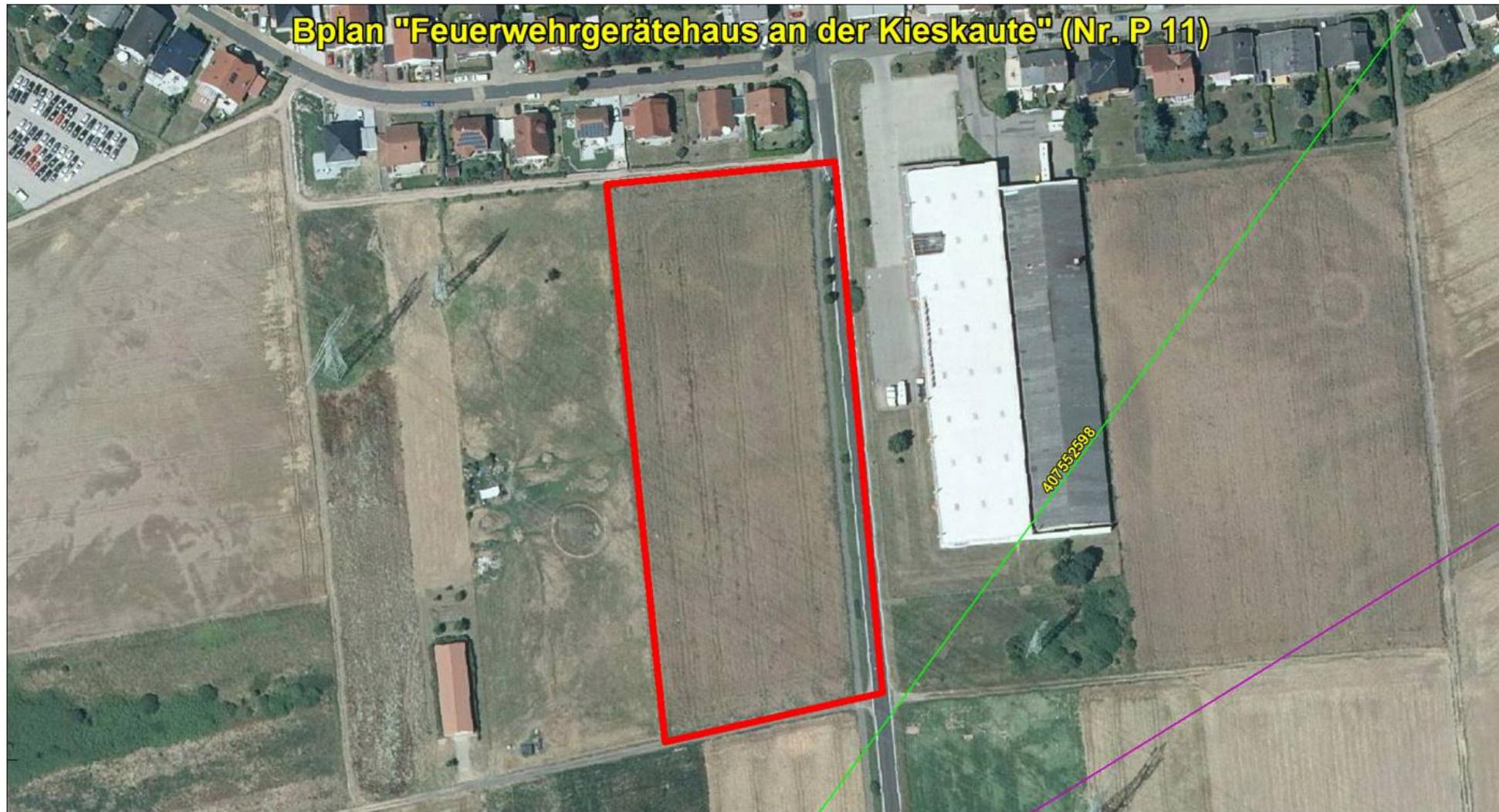
Die farbige Linie versteht sich als Punkt-zu-Punkt-Richtfunkverbindung der Telefónica Germany GmbH & Co. OHG. Das Plangebiet ist im Bild mit einer dicken roten Linie eingezeichnet.
