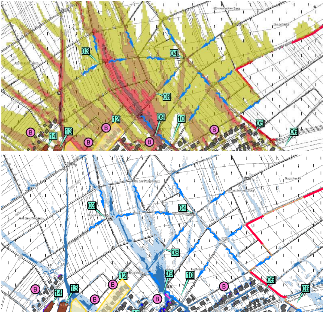
Abbildung 8: Starkregenabflusskarte (oben) und Sturzflutgefahrenkarte (unten)
