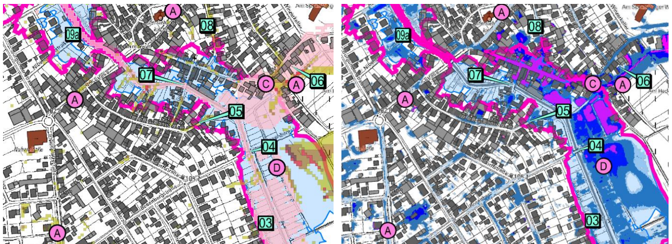
Abbildung 15: Starkregenabflusskarte (links) und Sturzflutgefahrenkarte (rechts)
