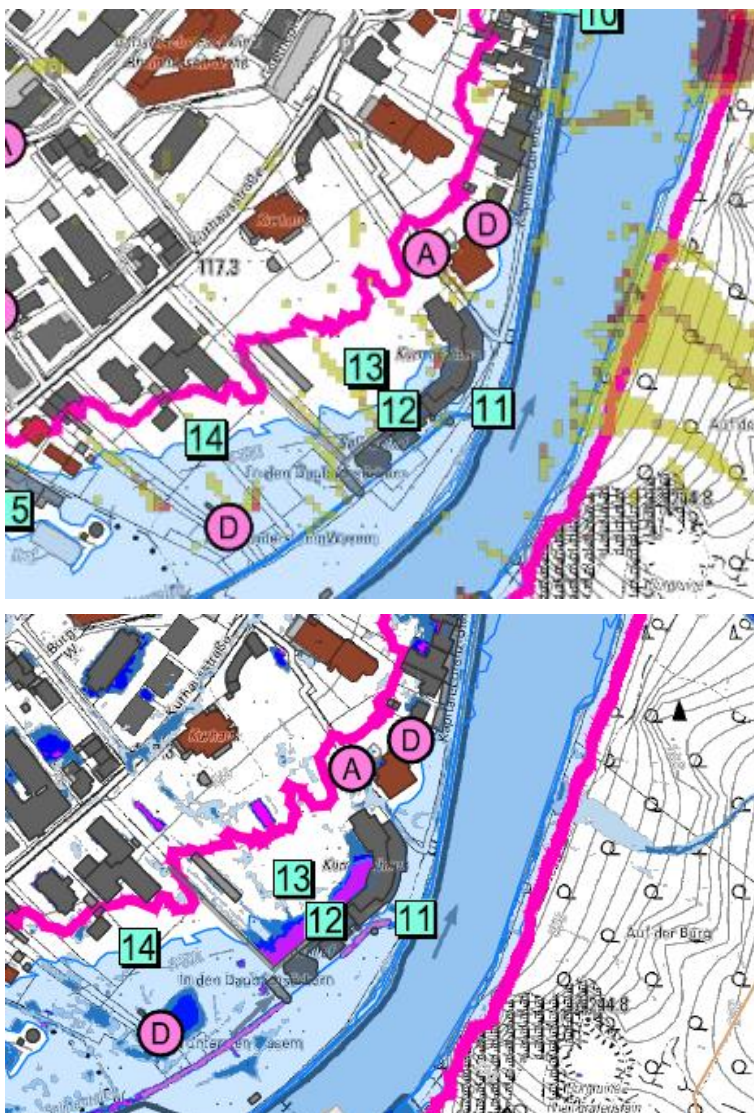
Abbildung 13: Starkregenabflusskarte (oben) und Sturzflutgefahrenkarte (unten)
