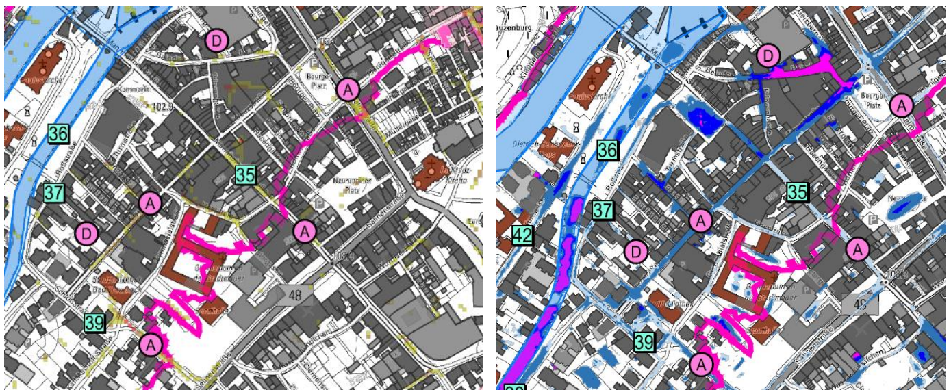
Abbildung 40: Starkregenabflusskarte (oben) und Sturzflutgefahrenkarte (unten)
