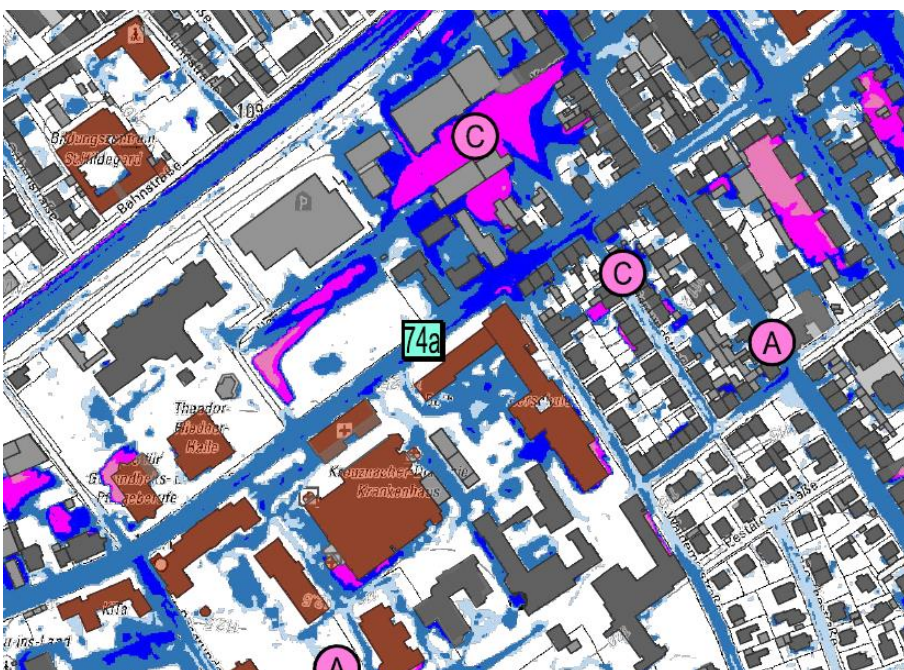
Abbildung 82: Starkregenabflusskarte (oben) und Sturzflutgefahrenkarte (unten)
