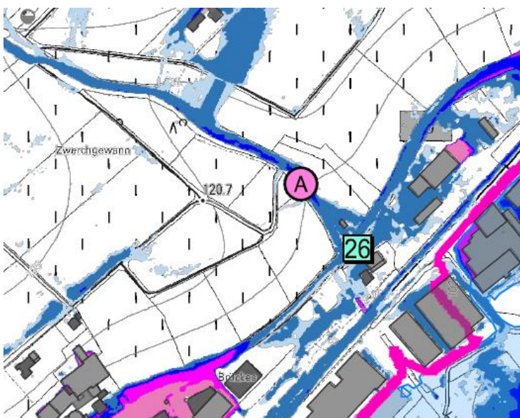
Abbildung 31: Starkregenabflusskarte (oben) und Sturzflutgefahrenkarte (unten)
