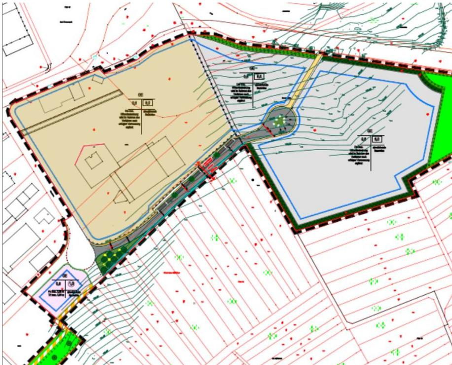
**Abbildung 10: Ausschnitt aus der Erschließungsplanung Ing.-Büro Albert Knodel GmbH (westlicher, farbig markierter Bereich wird über das bestehende Leitungsnetz in der Straße Riegelgrube entwässert)**
