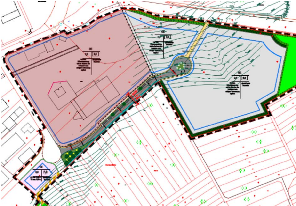
Abbildung 10: Ausschnitt aus der Erschließungsplanung Ing.-Büro Albert Knodel GmbH (westlicher, rot markierter Bereich wird über das bestehende Leitungsnetz in der Straße Riegelgrube entwässert)
